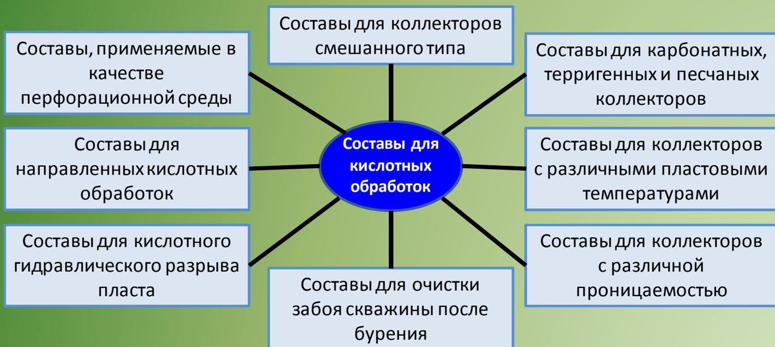
! Все кислотные составы «Химеко-ГАНГ» обладают низкой скоростью коррозии, что позволяет закачивать их при помощи комплекса ГНКТ или цементировочных агрегатов
