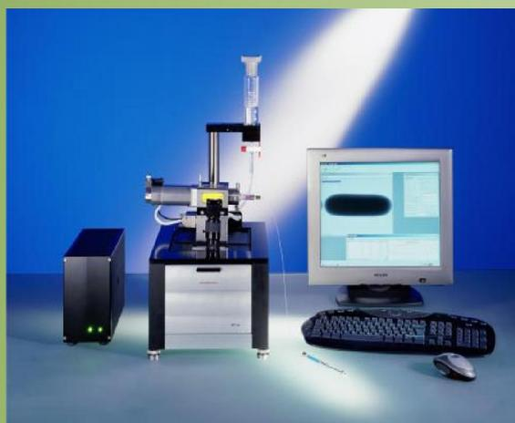
Сверхнизкие значения межфазного натяжения кислотных составов «ПАВ-СКС» на границе с углеводородами, обеспечивающего глубокое проникновение таких составов в пласт, могут быть измерены только на специальном Тензиометре
